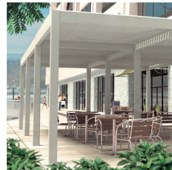
El diseño de las lamina del techo permite recoger el agua de lluvia mediante un sistema de canalización que hace posible el desagüe por los pilares laterales.
